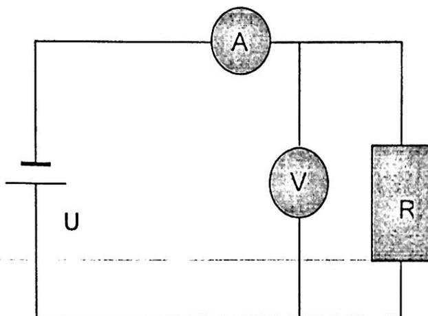
$$I_A = I_R + I_V \quad R = \frac{U_V}{I_R} = \frac{U_V}{I_A - I_V} = \frac{U_V}{I_A - \frac{U_V}{R_{i,V}}}$$
