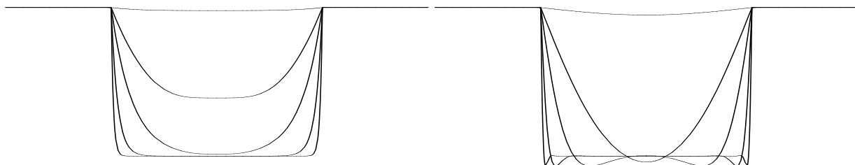
Obrázek 3. Efektivní a vybraná okamžitá hodnota podélné složky magnetického pole v tenké vodivé desce při hloubce vniku \delta/2a = 1, 0.3, 0.1, 0.03, 0.01 .
